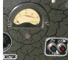
Kuva 2. Yhdistetty jännite- ja virtamittari sekä painonapit hehku- ja anodijännitteiden mittausta varten.
