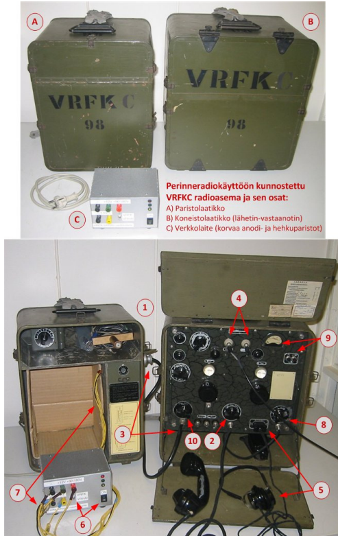
Kuva 1. VRFK -aseman osat ja käyttökuntoon laitto.
